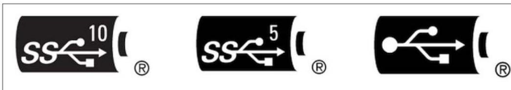
Abbildung 1: Symbole für Ladestandards - USB Version an: 5 GBit/s für USB 3.1 Gen 1 und 10 GBit/s USB 3.1 GEN 2
